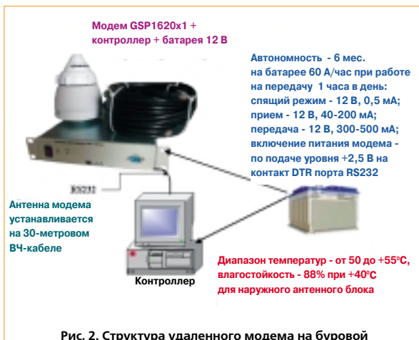
Рис. 2. Структура удаленного модема на буровой
